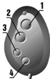
**Брелок системы имеет четыре кнопки и позволяет подавать девять команд.** Четыре команды передаются непосредственно нажатием соответствующей кнопки, три команды удерживанием кнопки 4 и нажатием одной из трех оставшихся, а также две команды удерживанием кнопки 3 и нажатием кнопки 1 или 2. За кнопками 1 и 2 жестко закреплены функции включения и отключения режимов охраны. Функциональное назначение остальных семи команд определяется при программировании системы.
